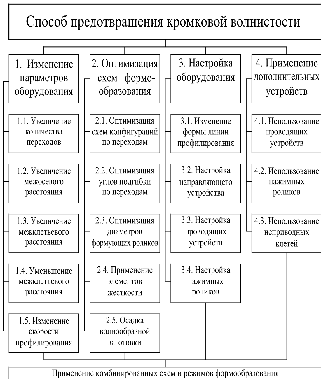
Рис. 2.1. Классификатор способов предотвращения кромковой волнистости
