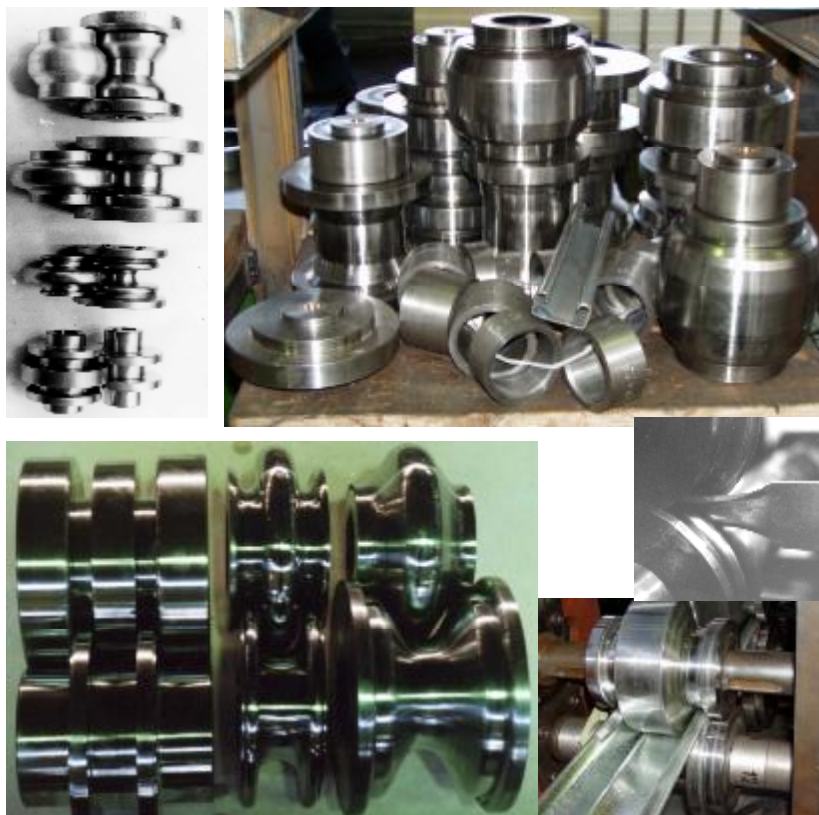
Рис. 4. Комплекты формирующих роликов для реализации технологии интенсивного формообразования
