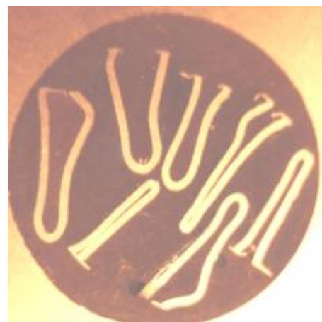
Рис. 2.11. Исследуемые образцы после прокатки в обжимных роликах
