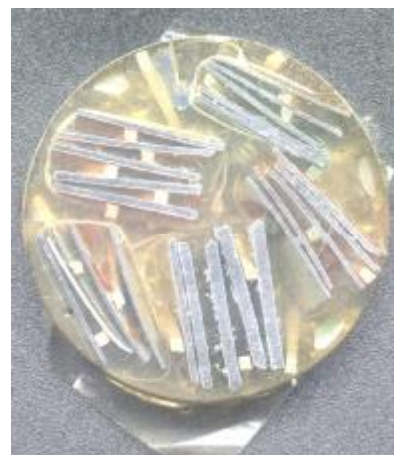
Рис. 2.25. Образцы после испытания на обжим
