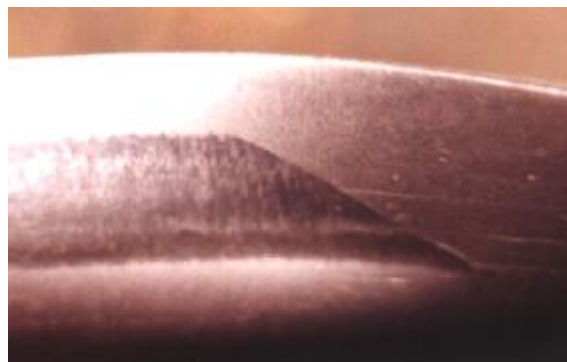
Рис. 4.12. Наличие следа на поверхности заготовки при подгибке на 90^\circ при предельных режимах подгибки ( \Delta\alpha = 90^\circ )
