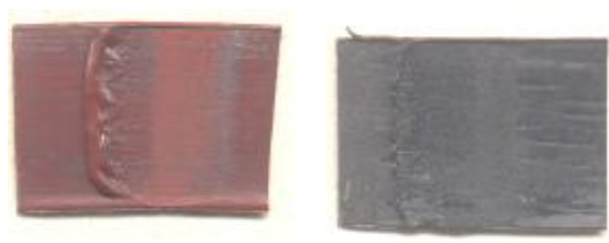
Рис. 2.28. Наплывы покрытия из полиуретана (№9) и пластизоля (№11) с исходной толщиной соответственно 70 и 100 мкм при обжиге в роликах 50%
