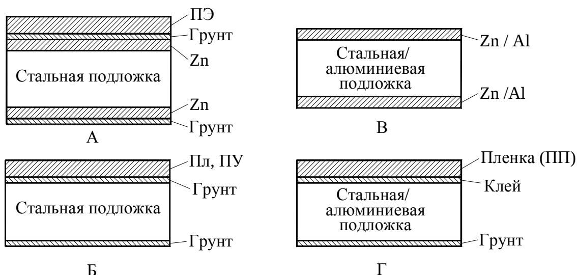
Рис. 2.4. Виды систем покрытий, применяемых при исследовании: А – ПЭ покрытие на стальной подложке, Б – Пл, ПУ покрытие на стальной подложке, В – Zn (Al) покрытие на металлической подложке, Г – пленочное покрытие на металлической подложке
