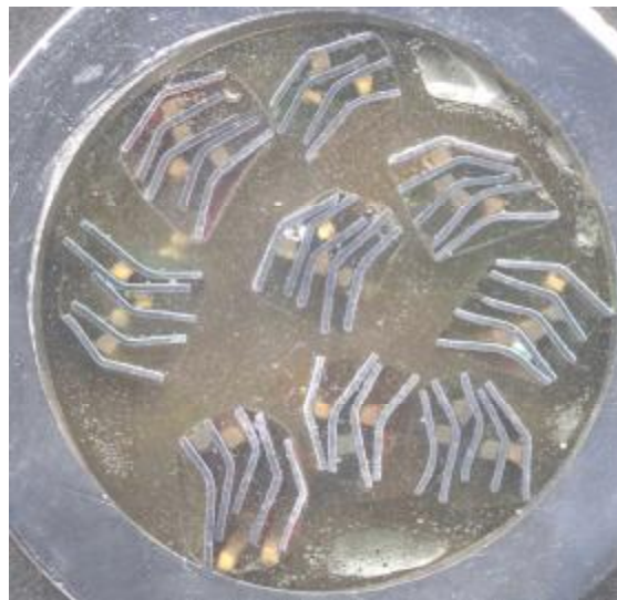
Рис. 4.21. Исследуемые образцы после прокатки через первый переход
