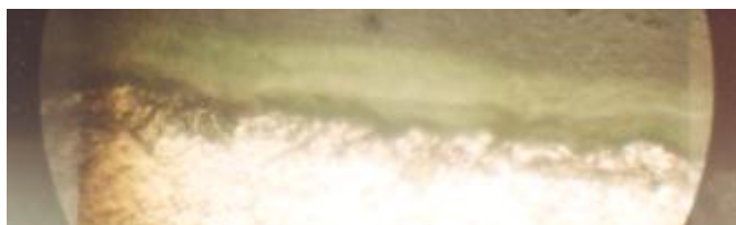
Рис. 2.27. Зона сцепления субстрата и покрытия после обжига в роликах (увеличение 400\times ), материал №1 –ПЭ (зел)-обжигание 37%
