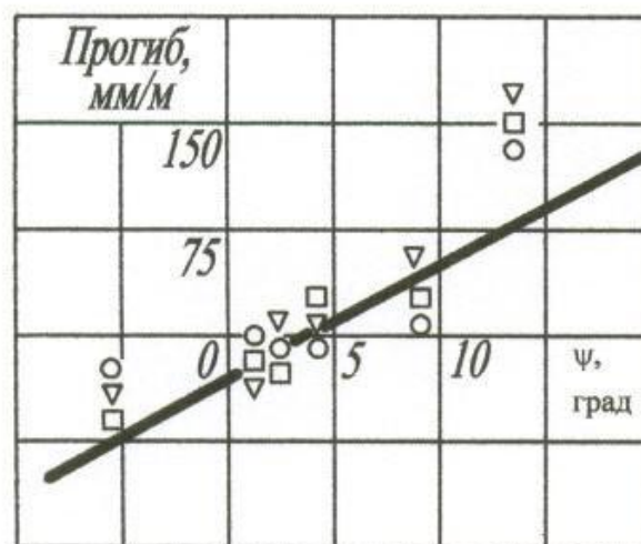
Рис. 4.8. Зависимость прогиба от угла захода: о – 1420, – Д16Т, ∇ – Д16М
