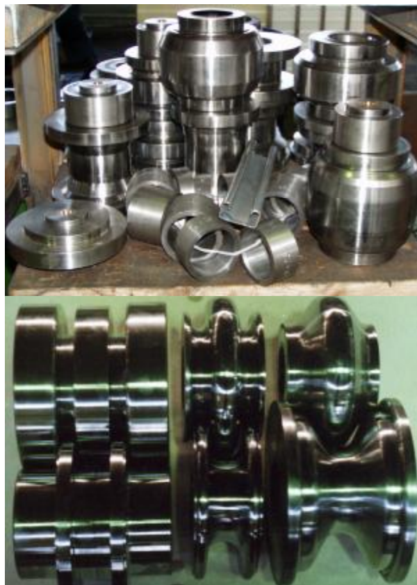
Рис. 7.16 Комплекты формирующих роликов для реализации технологии стесненного изгиба на станках семейства ГПС
