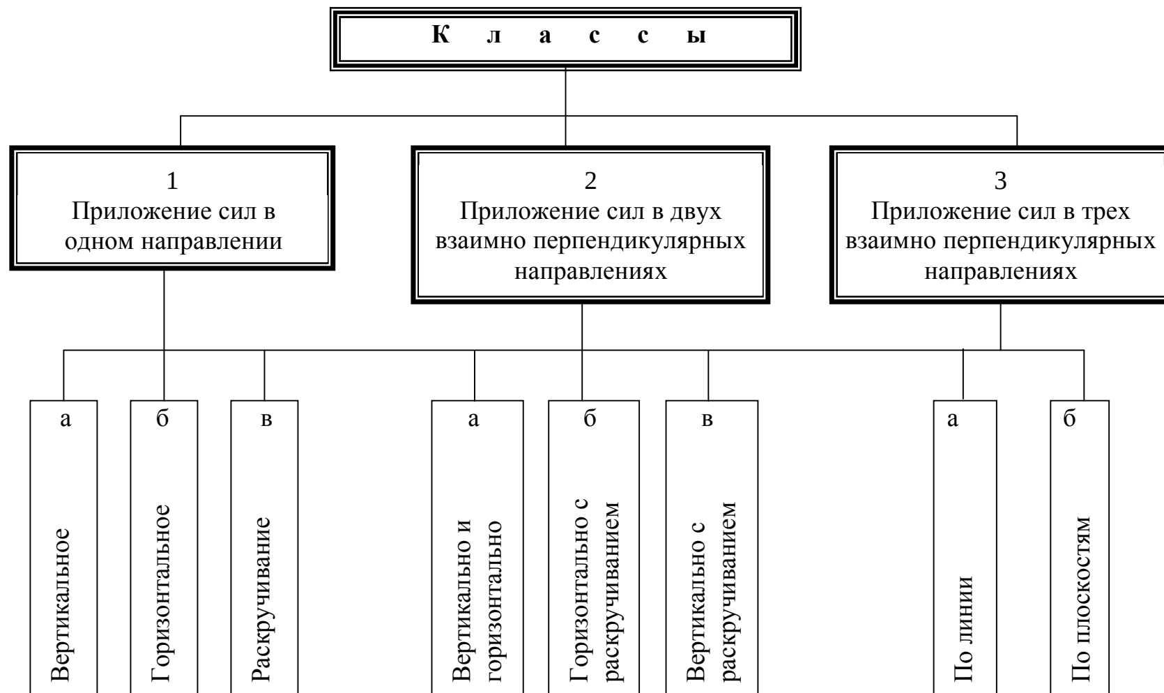
Рис. 2.5. Классификатор схем приложения сил для правки профилей при формообразовании
