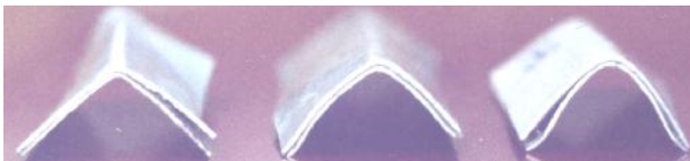
Рис. 5.13. Расслоение заготовок композита при гибке в роликах
