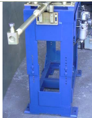
Рис. 6. Агрегаты автоматизированных линий: а – профилегибочный стан; б – пневматическое устройство для отрезки и перфорации профилей; в – синхронизатор шага перфорации; г – летучая пила для отрезки профиля
