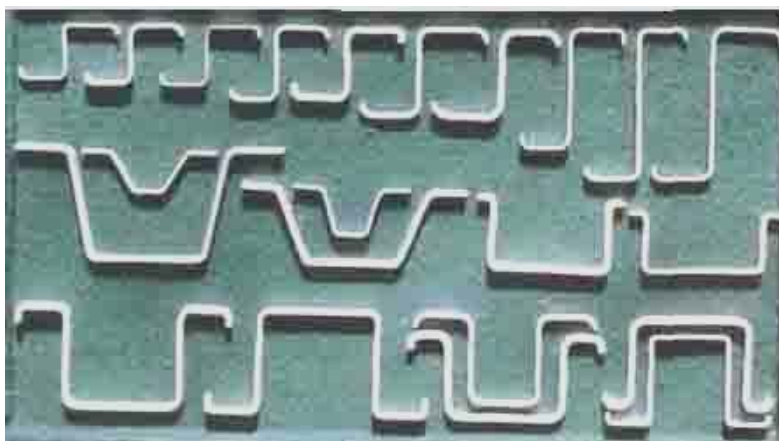
Рис. 5. Профили с покрытиями, производимые ОАО «Ульяновский НИАТ» и применяющиеся в качестве элементов стрингерного набора
