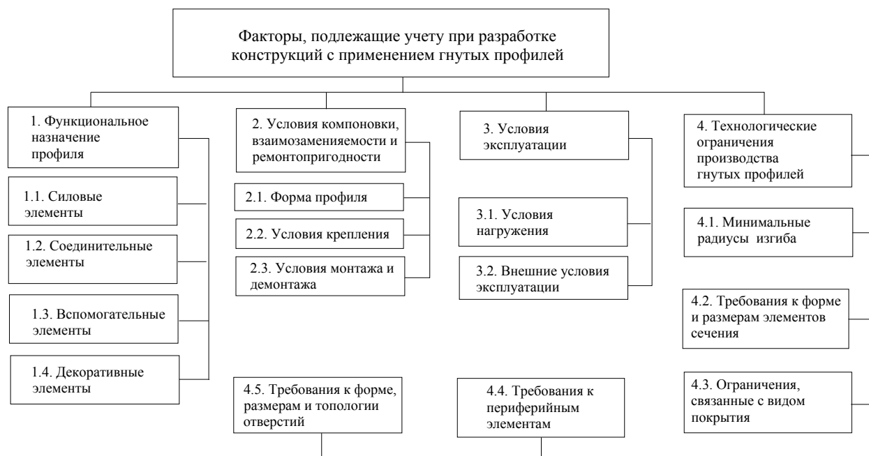
Рис. 1. Факторы, подлежащие учету при разработке конструкций с применением гнутых профилей
