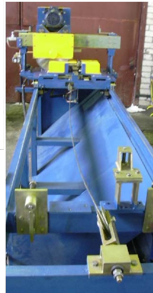
Рис. 6. Агрегаты автоматизированных линий: а – профилегибочный стан; б – пневматическое устройство для отрезки и перфорации профилей; в – синхронизатор шага перфорации; г – летучая пила для отрезки профиля
