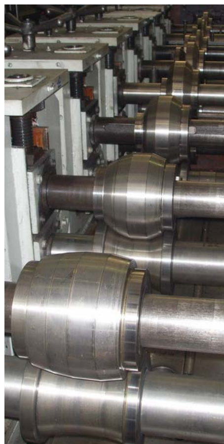
Рис. 2, б. Калибры 6, 7 и 8 переходов для изготовления профиля на начальной стадии испытания (станок ГПС-350М8)
