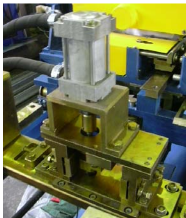
Рис. 6. Агрегаты автоматизированных линий: а – профилегибочный стан; б – пневматическое устройство для отрезки и перфорации профилей; в – синхронизатор шага перфорации; г – летучая пила для отрезки профиля
