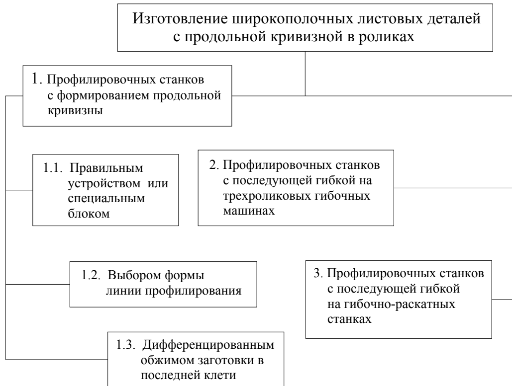
Рис. 1. Классификатор способов изготовления в роликах широкополочных листовых деталей с продольной кривизной
