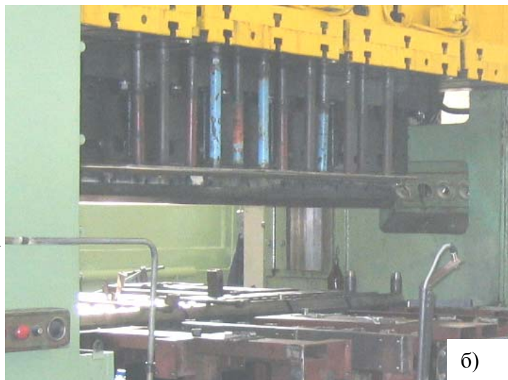
Рис. 3. Схема гибки заготовки в штампе (а) и размещение штампа с прижимом на прессе (б)
