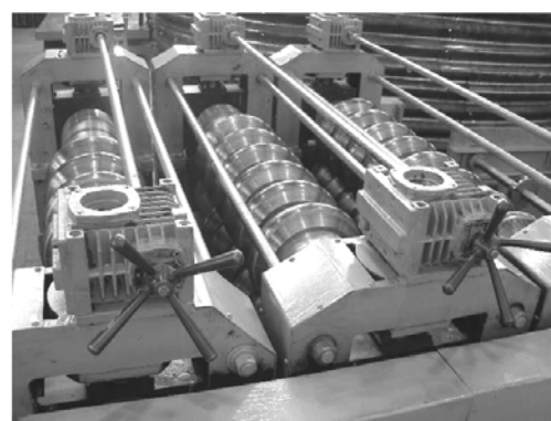
Рис. 5. Калибровочная машина МК1140: а – схема (вид сверху); б – машина в сборе
