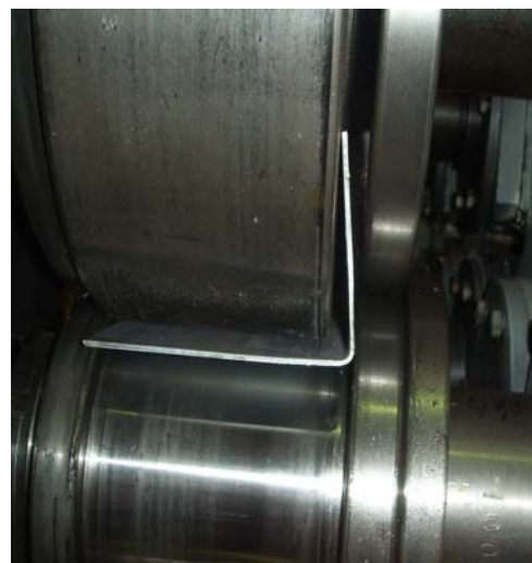
Рис. 6. Раскатка полки в роликах: а – схема раскатки; б – раскатные ролики
