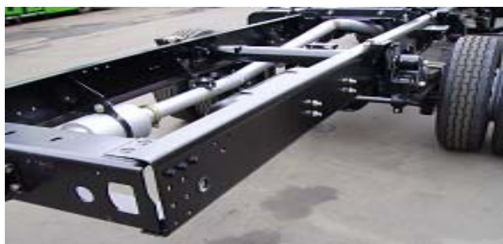
Рис.1. Внешний вид лонжеронной рамы из гнутого профиля грузового автомобиля с технологическими отверстиями
