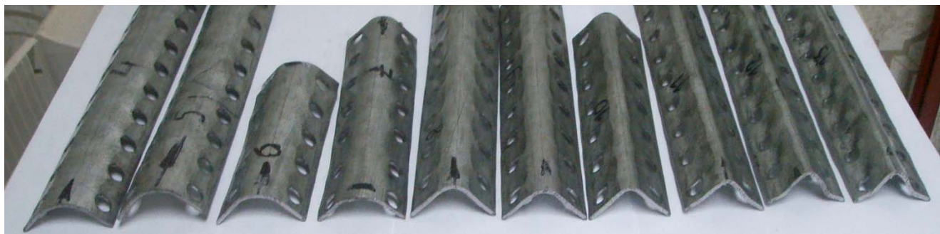
Рис. 9. Образцы с различной величиной зазора H (крайне левый H=9 мм, крайне правый H=0 )
