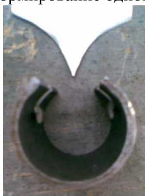
Рис. 9. Загиб отходов внутрь профиля
