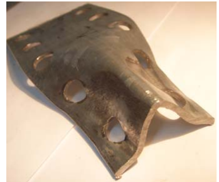
Рис. 10. Зона плавного перехода уголка при осадке
