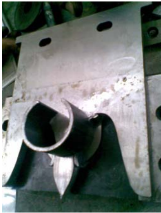
Рис. 3. Непрорубание элементов профиля клиновидным ножом
