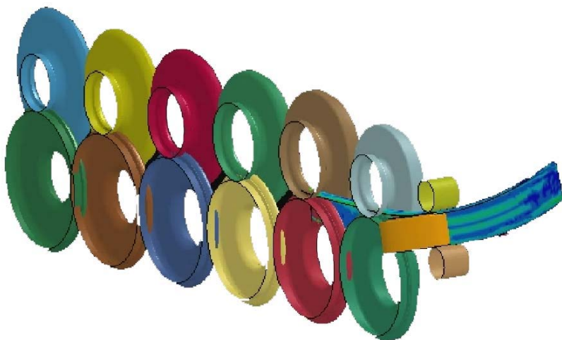
Рис. 4. Моделирование процесса изготовления профиля шпангоут с продольной кривизной
