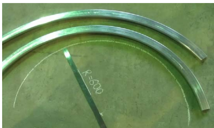
Рис. 2. Гнутые профили с продольной кривизной полученные при гибке-прокатке на станке ГПС
