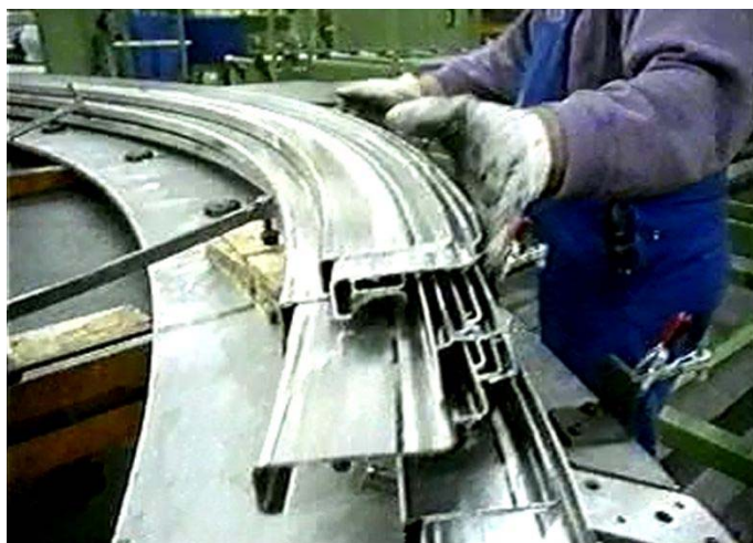
Рис. 7. Заготовки шпангоутов для самолета Airbus A320 полученные на автоматизированной линии компании Premium Aerotec
