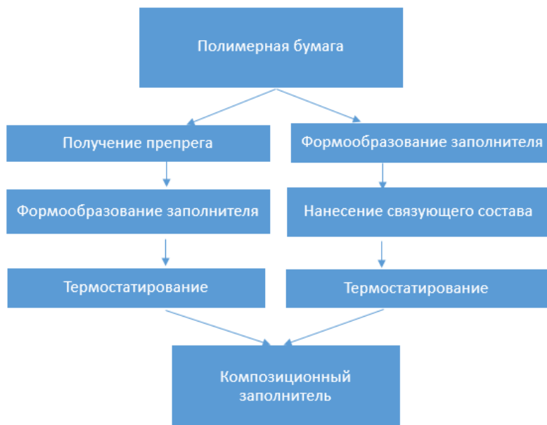
Рис. 1. Пути получения заполнителя из полимерных бумаг
