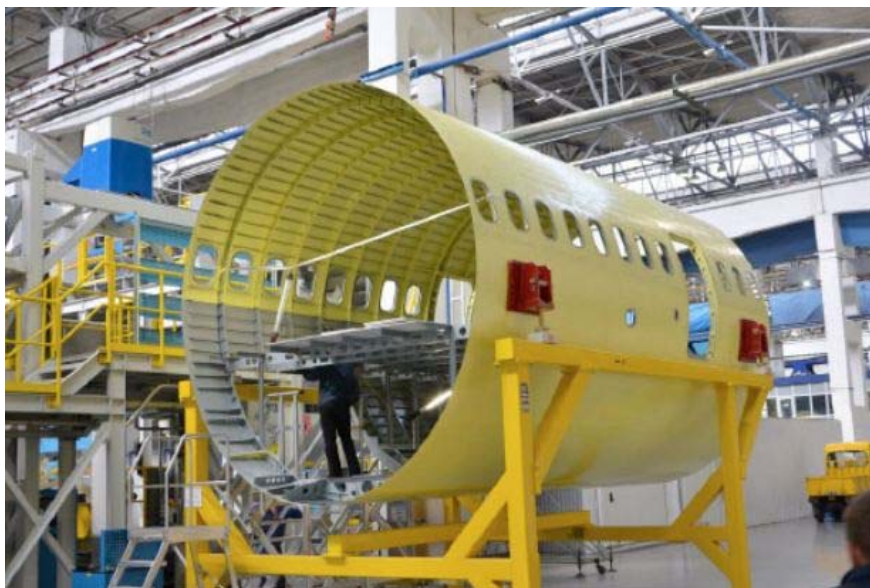
Рис. 1. Отсек фюзеляжа самолета МС-21 со стрингерами и шпангоутами
