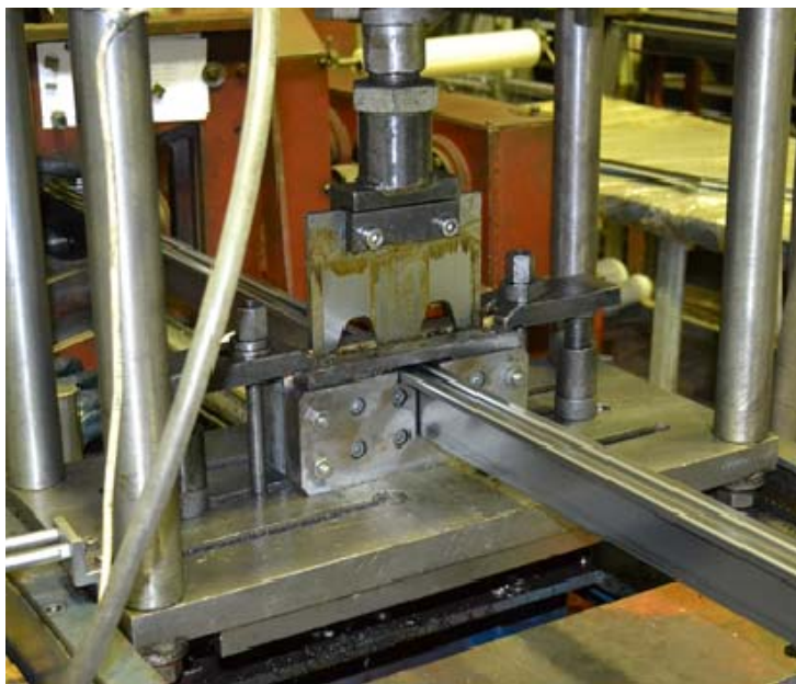
Рис. 3. Общий вид отрубного устройства со стандартным типом штампа
