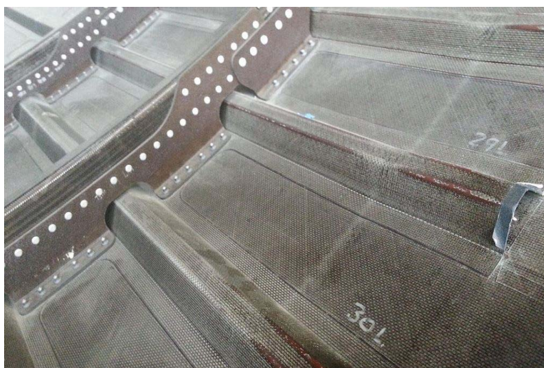
Рис. 2. Панель фюзеляжа самолета Boeing 787 с неметаллическими стрингерами
