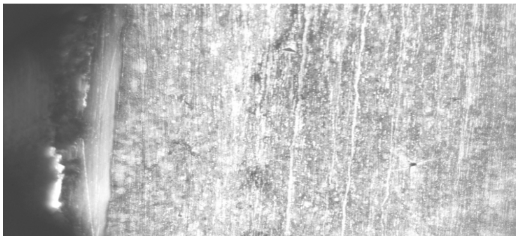
Рис. 2. Структура травленого шлифа биметалла Сталь-Медь под увеличением x50
