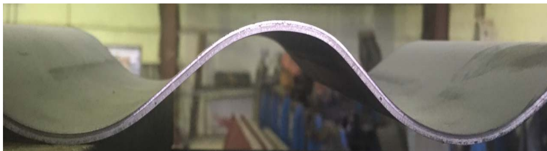
Рис. 3. Образец плоского СГЛ, полученного на экспериментальной установке роторного гофрирования
