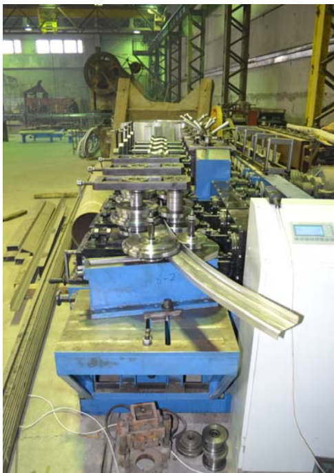
Рис. 3. Экспериментальная установка для изготовления заготовок шпангоутов
