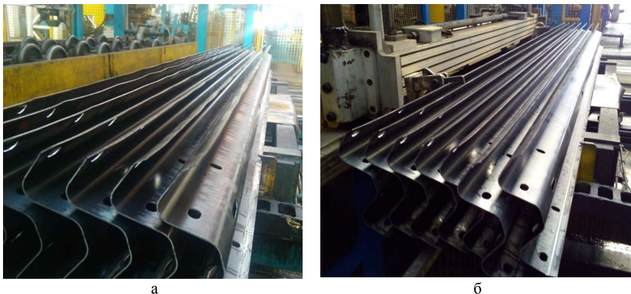
Рис. 4. Практические испытания: а - наличие дефекта кромковой волнистости, б - кондиционный профиль без дефектов
