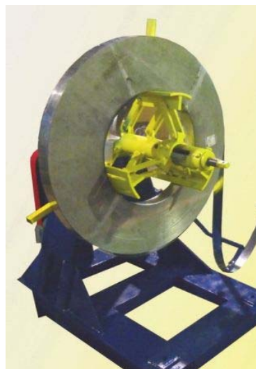
Рис. 2. Разматывающая рулонница с системой контроля натяжения
