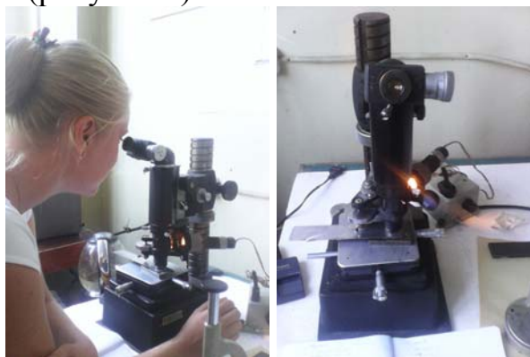
Рисунок 3,4 – Работа за прибором ПМТ-3. Испытание образцов на микротвердость
