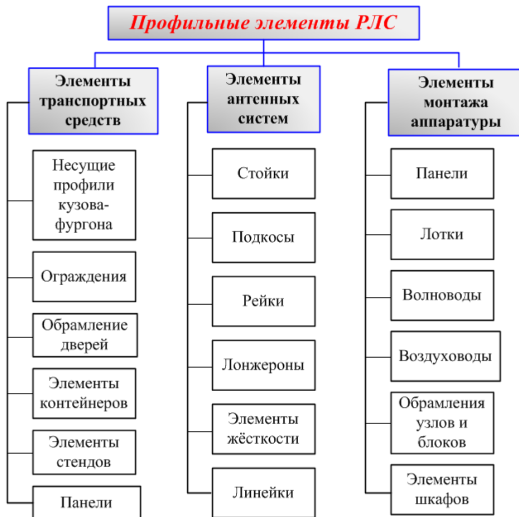
Рис. 2. Профильные детали и элементы в составе РЛС
