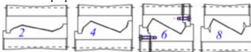
Рис. 4. Расположение профиля в валках: на шестом переходе валки выполнены сборными для доступа инструмента в будущие зоны формовки отбортовок
