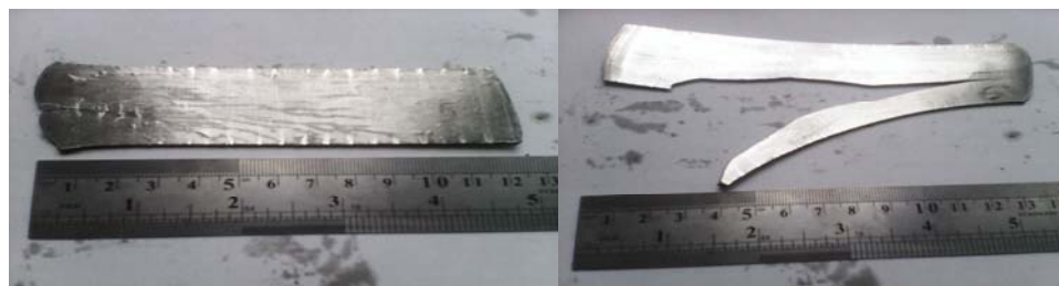
Рисунок 8 – Образец 3 а) и образец 4 б) после второго прохода прокатки
