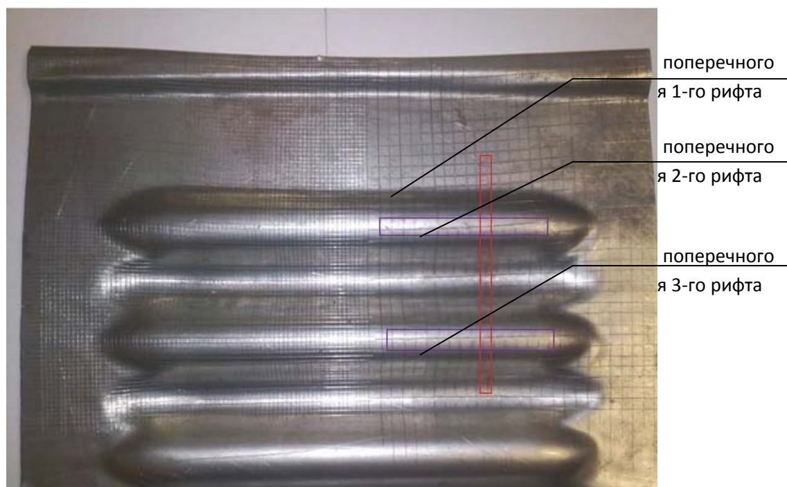
Рис. 3. Штампованная панель с обозначением зон замеров деформации
