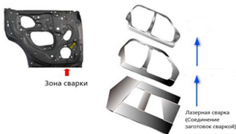
Рис.1 Изделия кузова автомобиля из сварных листовых заготовок
