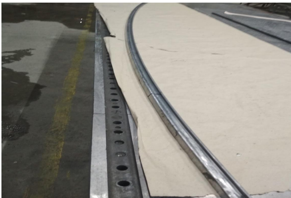
Рис. 2. Заготовка стрингера 7 на инструментальной плите после правки
