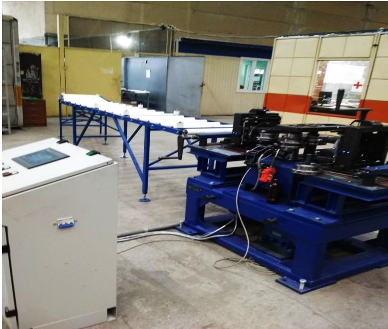
Рис. 1. Установка правильно-гибочная роликовая на испытаниях
