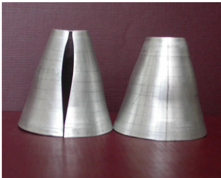
Рис. 3 - Деталь без сварного шва
