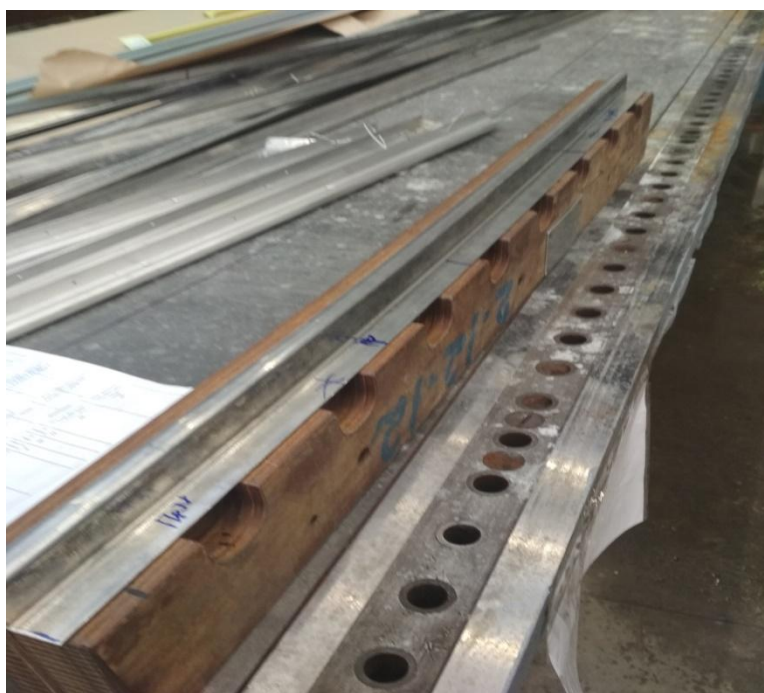
Рис. 3. Заготовка стрингера 13 на КДП после правки на УПГР
