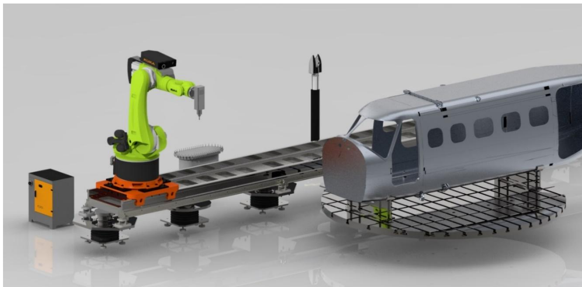
Рис. 1 – Концепция роботизированного комплекса для фрезерной обработки
