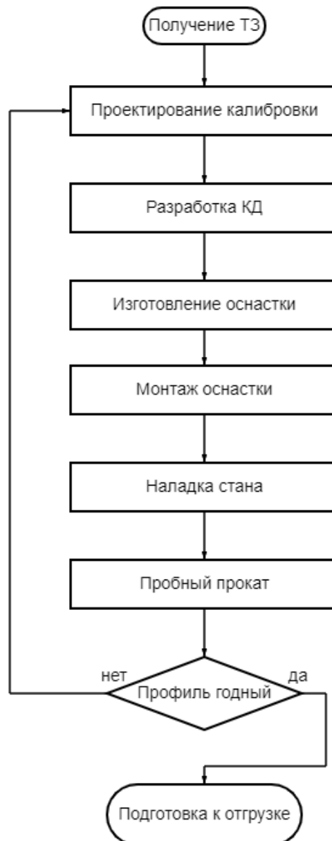
Рис. 2. Блок-схема итерационного способа
