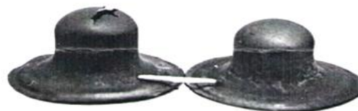
Рис. 4. Форма выдавленных образцов из титанового сплава ОТ4-1, л. 0,3
