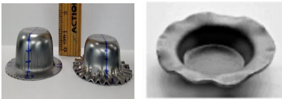
Рис. 1. Гофрообразование на фланце
