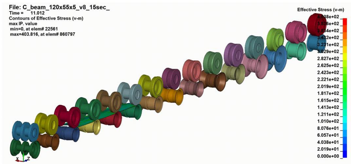
Рис. 2. Моделирование процесса формообразования заготовки в роликовых калибрах для профиля – стойка дорожная 120x55x5
