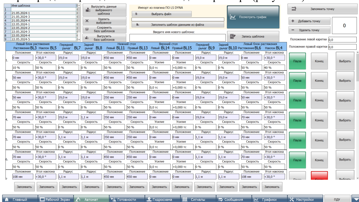
Рисунок 4. Матрица управляемых координат на интерфейсе АРМ оператора растяжно-обтяжного прессы РО-3М
