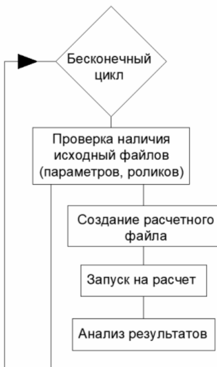
Рисунок 9. Укрепленный алгоритм работы программы DynaRollForm
