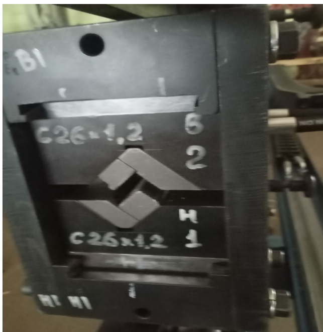
Рисунок 3. Зажимные губки УППР-1 для Z-образного профиля
