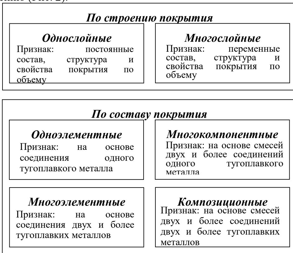
Рисунок 2. Обобщенная классификация износостойких покрытий для инструмента
