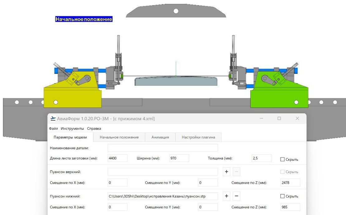
Рисунок 6. Начальное положение обтяжного пуансона и листовой заготовки
